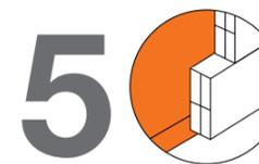
**5** Generar el cerramiento interior creando una cámara de aire entre el aislante y el ladrillo. La tabiquería interior deberá pisar el solape inferior y superior del aislante.
