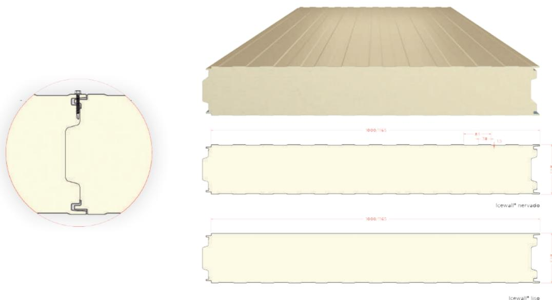
**Panel para cámaras de frío.** Panel aislante compuesto por dos chapas metálicas en perfiles, unidas por un núcleo aislante de espuma rígida de poliuretano (PUR) o polisocianurato (PIR). Panel autoportante de alto espesor para cámaras de frío industrial. Solución de gran versatilidad y facilidad de montaje, para ambientes con temperatura controlada.
