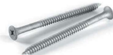
El sistema TERMOFIX esta compuesto de tornillo de acero y arandela tubular telescópica de plástico. La capacidad de perforación del tornillo sobre chapa de acero es de 0,88 mm. Punta de broca reducida, impronta Phillips PH-2.
