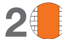
**2** Colocar AIR-BUR TERMIC sobre el paramento en sentido vertical tensando el material.
