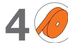
**4** Solapar 10 cm una lámina sobre otra y sellar la unión con cinta adhesiva de aluminio.
